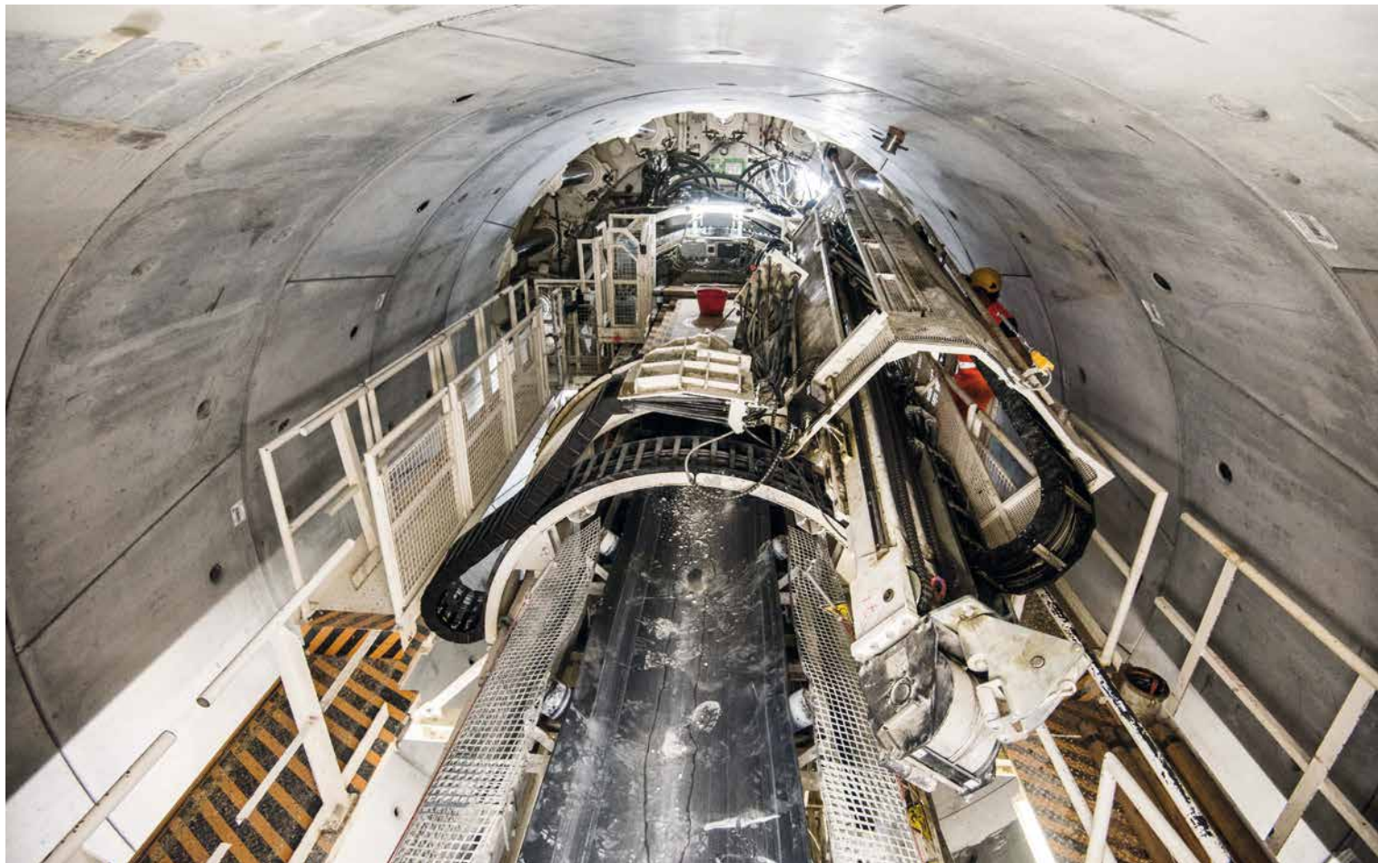
Auf einer „geschlossenen“ Doppelschild TBM Su una fresa „chiusa“ a doppio scudo
