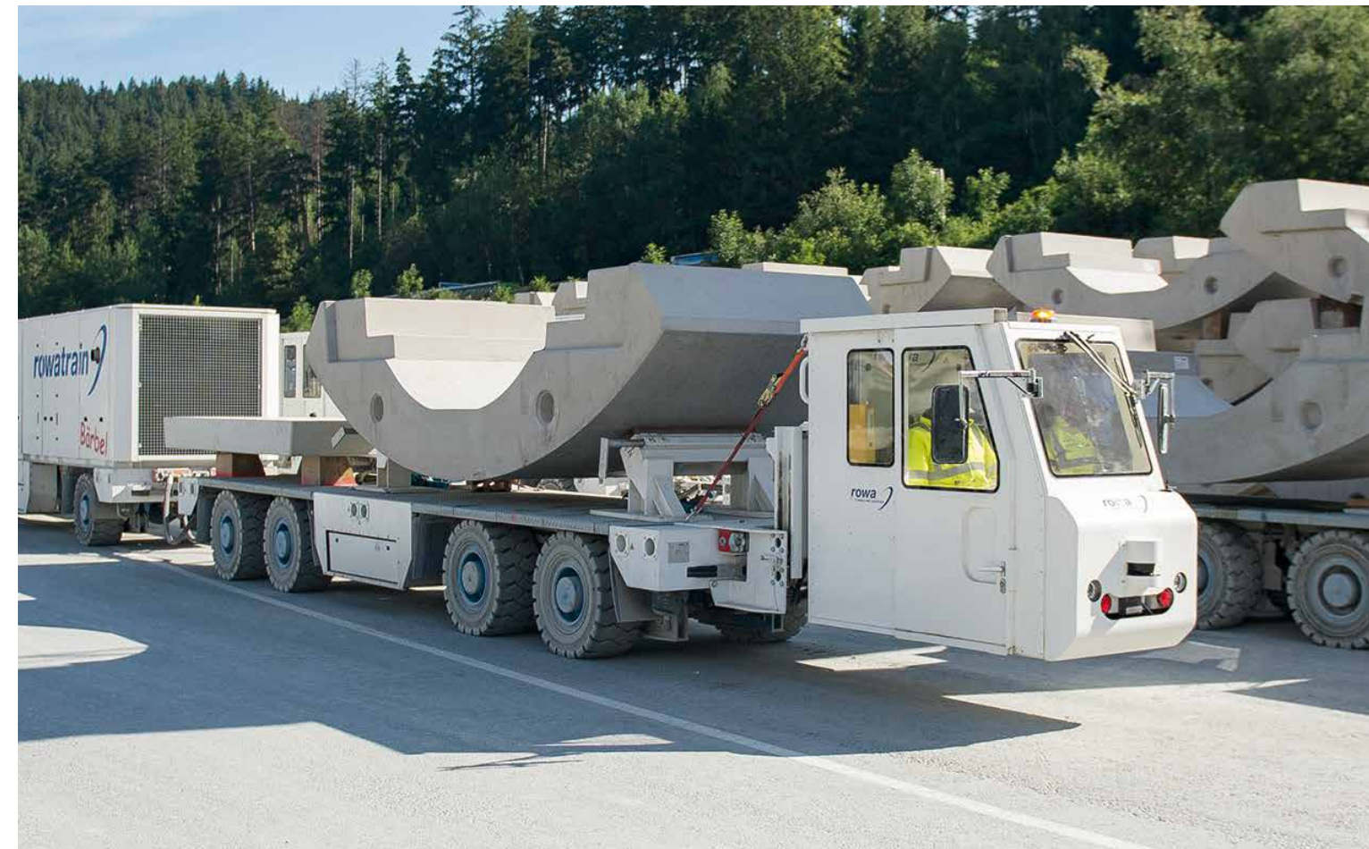
Das sogenannte „Multi Service Vehicle“ für die Versorgung der TBM im Erkundungsstollen Ahrental-Pfons Il cosiddetto „Multi Service Vehicle“ per l'approvvigionamento della fresa nel cunicolo esplorativo di Ahrental-Pfons
