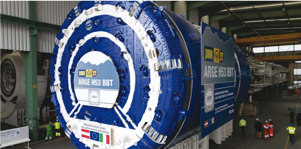
Doppelschild TBM Wilma im Herstellerwerk der Firma Herrenknecht Wilma, la TBM a doppio scudo, nello stabilimento di produzione Herrenknecht
