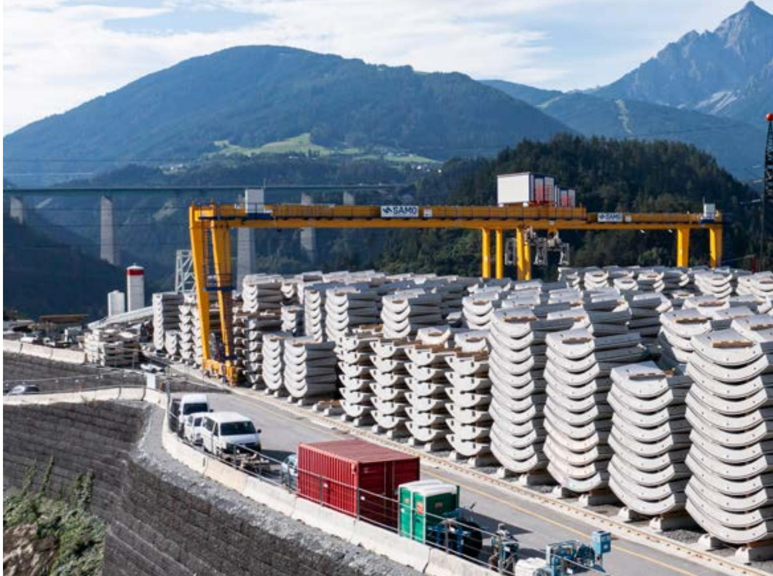
Im Haupttunnel besteht ein Ring immer aus sechs Tübbingen. Mehrere Ringe aneinander gereiht ergeben die fertige Betoninnen schale des Brenner Basistunnels.
