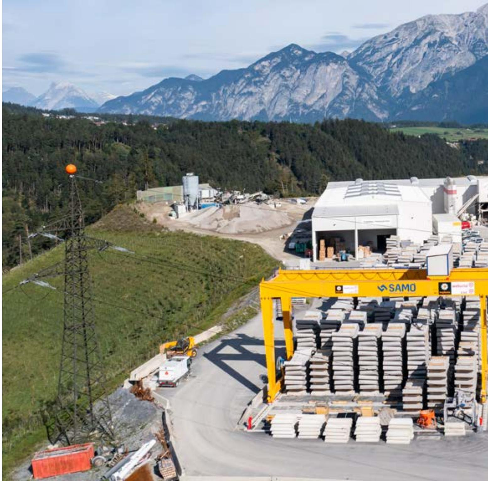
Die Tübbingteile werden direkt auf der Baustelle gefertigt
