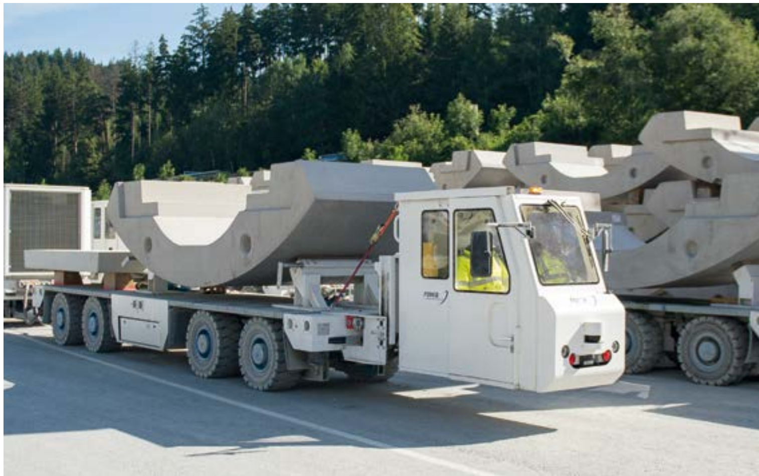
L'approvvigionamento della fresa nel cunicolo esplorativo di Ahrental-Pfons è stato svolto dal così detto „Multi Service Vehicle“.
