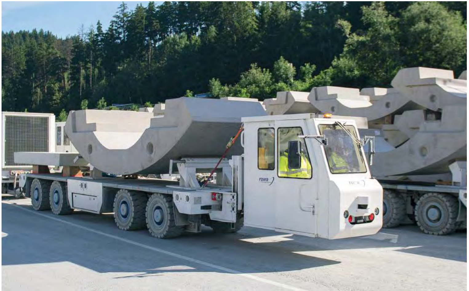
Das sogenannte „Multi Service Vehicle“ war für die Versorgung der TBM im Erkundungsstollen Ahrental-Pfons zuständig.
