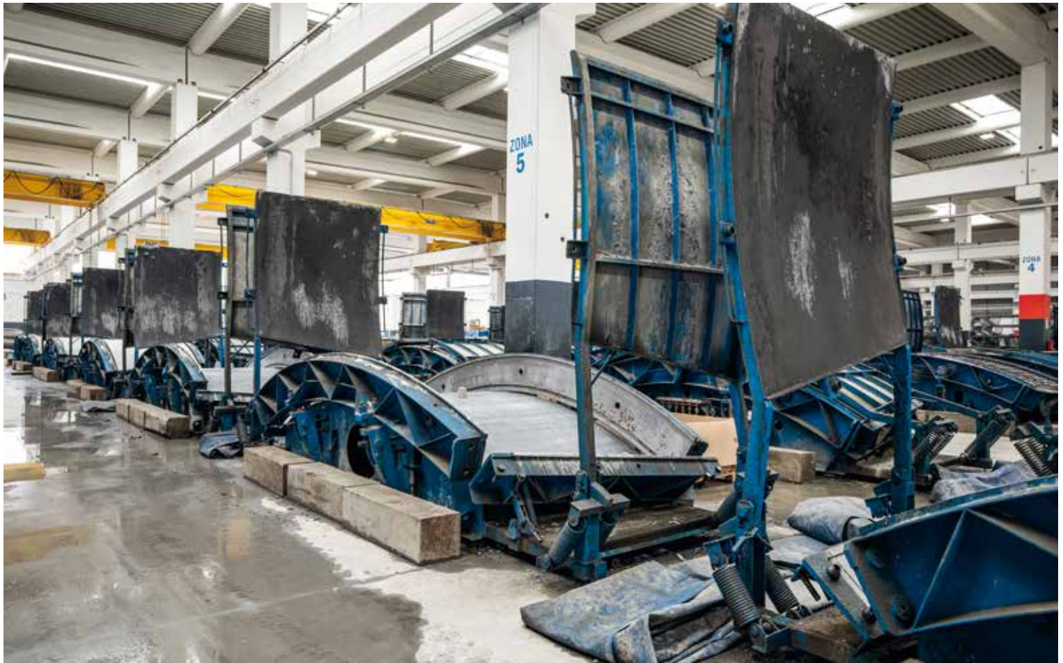
Zahlreiche Tübbingschalungen sind zur Fabrikation der Betonfertigteile vonnöten Sono necessari diversi stampi per conci per poter realizzare gli elementi prefabbricati
