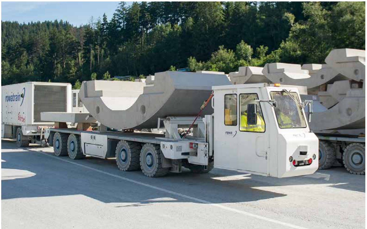
Das sogenannte „Multi Service Vehicle“ für die Versorgung der TBM im Erkundungstollen Ahrental-Pfons Il cosiddetto „Multi Service Vehicle“ per l’approvvigionamento della fresa nel cunicolo esplorativo di Ahrental-Pfons
