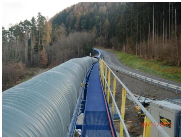
Förderbandanlage zur Deponie Ampass Süd / impianto di nastro trasportatore verso il deposito Ampass
