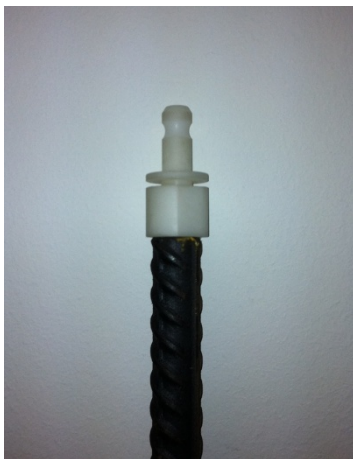
Bild / Immagine 7: Eisenstangen mit Prismenadapter / Stanghe di ferro con adattatore per prismi
