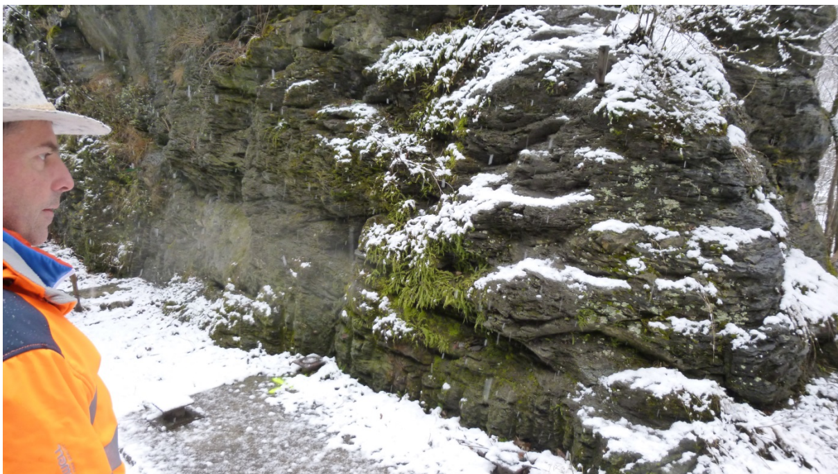
Abbildung 7 Aufnahme 5 auf Felsnase, horizontale Schiefe- rung des Felsens erkennbar
